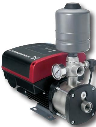
Grundfos CME Booster je kompaktan sistem za povišenje pritiska dizajniran za vodosnabdevanje. CME Booster može zadržati pritisak u cevovodu na konstantnom nivou pomoću kontrole brzine. Promene u potrošnji vode se prate preko senzora pritiska, koji šalje signal regulatoru brzine za promenu brzine motora, tako da sistem može da se prilagodi novim uslovima rada.
