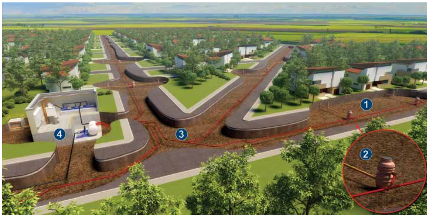
PLANUL TIPIC AL UNUI SISTEM DE CANALIZARE CU VID
