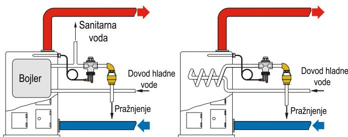
Instalacija ispusnog ventila za termičku zaštitu na kotlu sa bojlerom.
