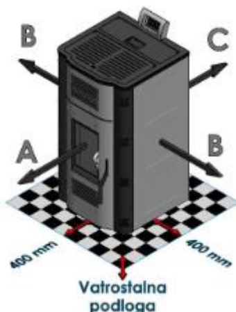
Slika 8. Prikaz udaljenosti kamina od nepokretnih objekata
