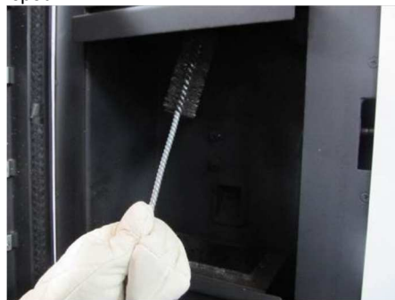
Čišćenje cevi izmenjivača komore
