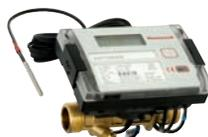
Contatore di calore statico ad ultrasuoni composto da: componente ultrasonico per la misurazione del volume; integratore con hardware e software integrale per la misurazione della portata, della temperatura e del consumo di energia; con due ingressi di segnale impulsivo e trasmissione secondo modalità M-BUS; due sonde di temperatura PT 500.
