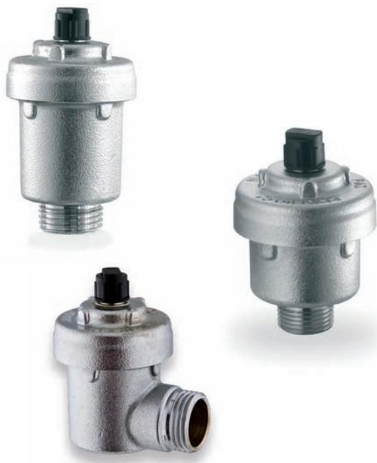
Le valvole automatiche di sfogo aria **te-sa**, svolgono la funzione di evacuare automaticamente l'aria che si trova negli impianti di riscaldamento sia durante la procedura di caricamento impianto, sia durante il normale funzionamento (degasaggio).
