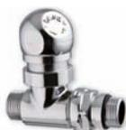
Valvola termostattizz. e detentore diritti per termoarredo. Attacchi radiatore e tubazione 1/2"; codolo con battuta a tenuta O-ring. Corpi valvole e manopola detentore in ottone. Vitoni in ottone con tenute in EPDM. Manopola valvole in ABS.
