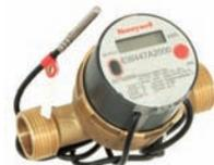
Contatore di calore dinamico per riscaldamento e raffrescamento composta da: componente meccanico per la misurazione del volume; integratore con hardware e software integrale per la misurazione della portata, della temperatura e del consumo di energia; con trasmissione secondo modalità M-BUS; due sonde di temperatura; filtro a Y con predisposizione per pezzetto porta sonda per misure da 1 1/4" - 2".
