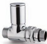
Valvola manuale e detentore diritti per termoarredo. Attacchi radiatore e tubazione 1/2"; codolo con battuta a tenuta O-ring. Corpi valvole e manopola in ottone. Vitoni in ottone con tenute in EPDM.
