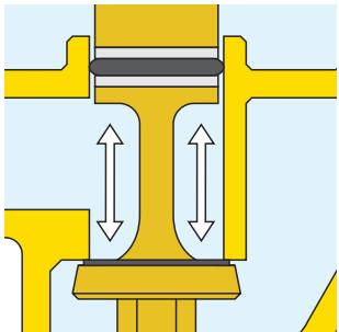
Na slici, sile pritiska u pravcu otvaranja ventila su u ravnoteži s obzirom da su površine na pećurki ventila i vretenu jednake.
